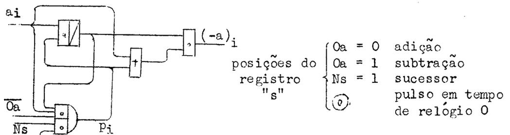
Fig. 10 - Circuito para Inverter o Sinal de um Número
