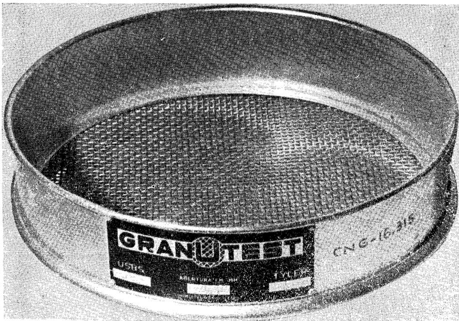
Fig. 4 — Peneira usada na granulometria. Se compõe de um anel metálico que se encaixa sobre o anel da malha que lhe é inferior.
