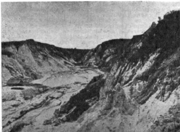
Fig. 23 — A famosa mina de diamantes de São João da Chapada. A depressão, entulhada, sobre o quartzito, já está, atualmente, reescavada, aparecendo aquêle em vários pontos das paredes da mesma, bem como no fundo. Esta mina tem produzido alguns dos melhores diamantes brasileiros.
