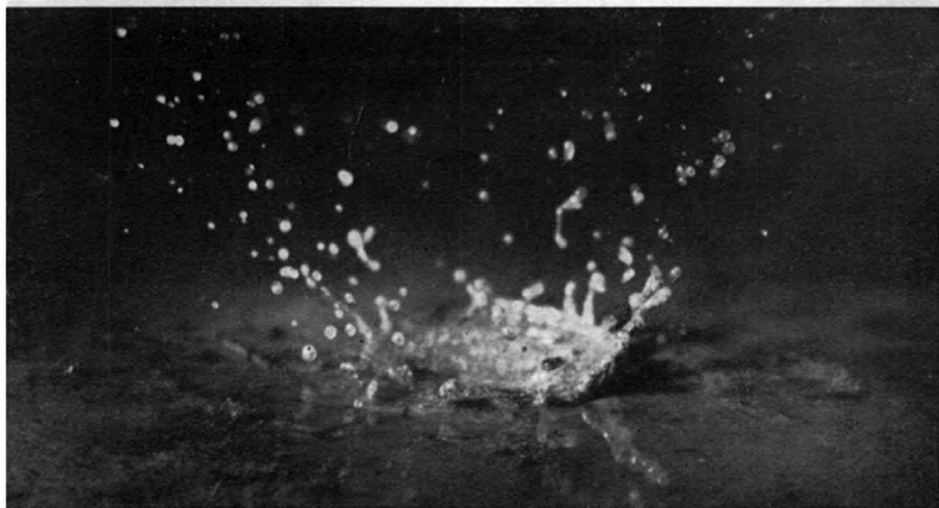
Fig. 1 — Erosão-por-salpico. Cada gôta de chuva que impinge sôbre o terreno desprotegido age como uma bomba em miniatura. Em cima, uma gôta de chuva aproxima-se do solo sôbre o qual existe delgada película de água; no meio, o impacto arroja para o ar água e partículas de solo e de matéria orgânica; em baixo, a depressão deixada evidencia a eficiência da erosão-por-salpico. Tamanho natural. — (Fotografia de V. P. Robey. Naval Research Laboratory, Washington, D. C., cortesia de W. D. Ellison).
