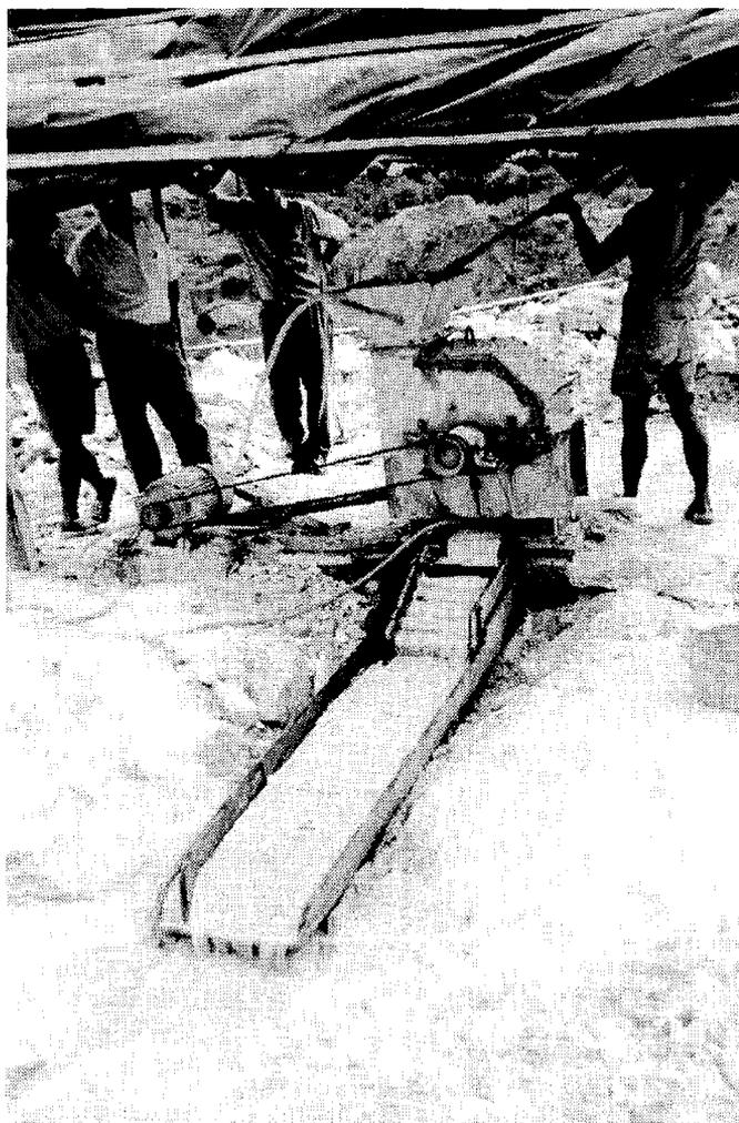
Foto 17 - Caixa de concentração do ouro Observar que há um moinho na parte superior Trata-se de material que precisa ser reduzido Garimpo do Tartarugalzinho (abr 1994)
