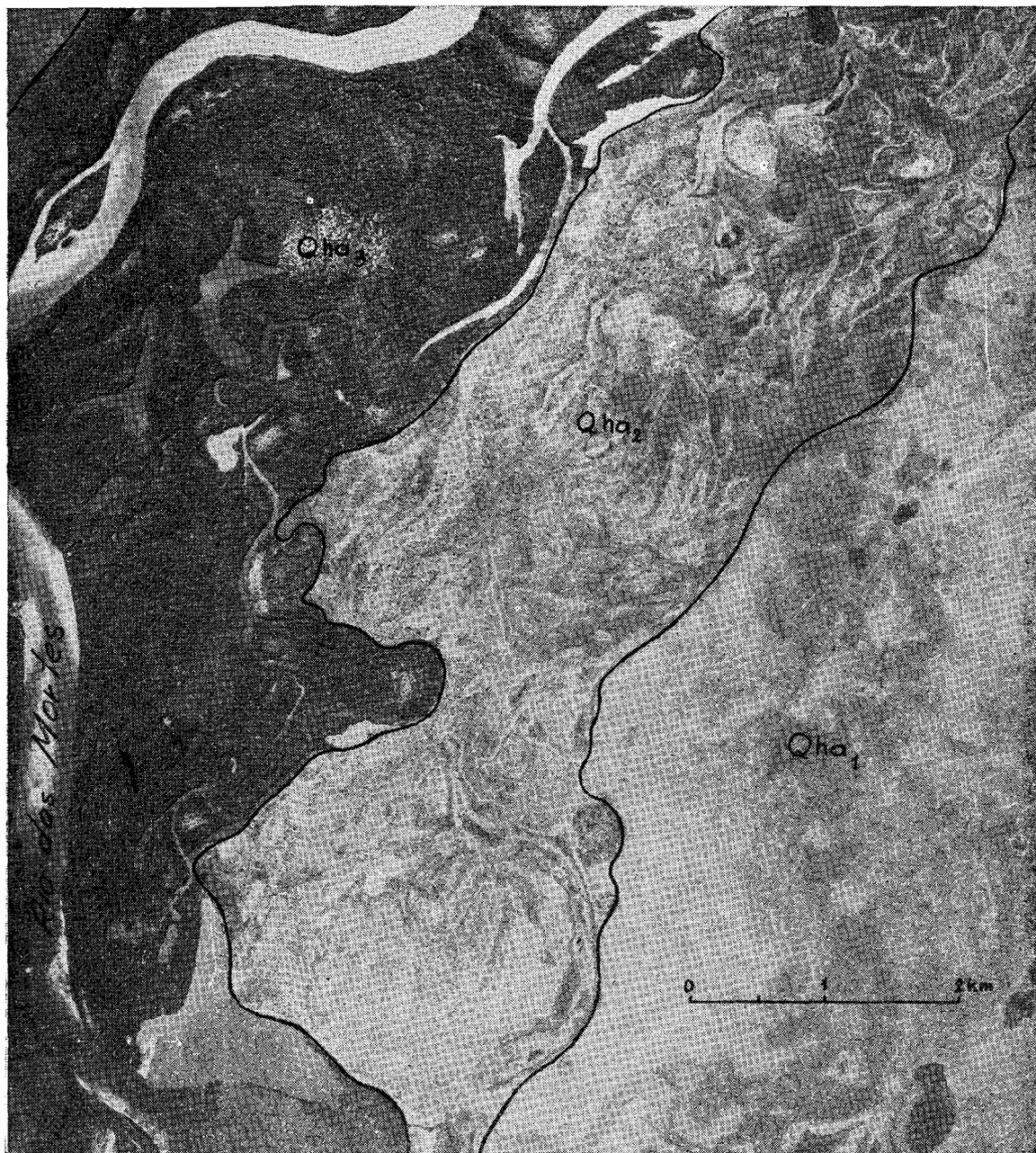
Foto n.º 12 — Área aluvionar nas proximidades da confluência dos rios Araguaia e das Mortes. Observa-se distintamente três estágios de aluvionamento que deixaram depósitos em níveis diferentes. O índice 1 é o mais velho. (Aerofoto PROSPEC S.A.).
