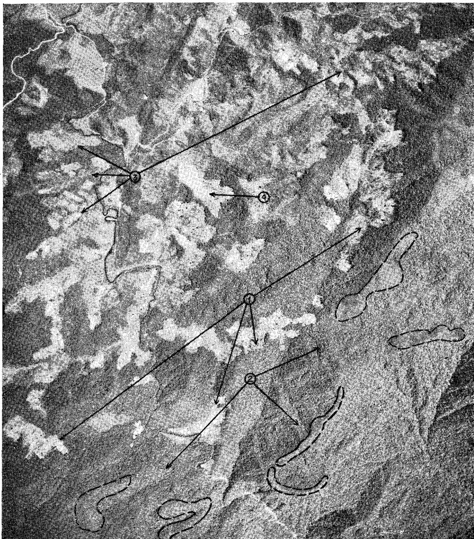
Fig. 1 — Fotografia aérea de uma área na serra do Retiro, divisa de São Paulo com Rio de Janeiro, onde se distinguem: 1) Áreas em corte; 2) Áreas de vegetação baixa nos pontos mais altos, o que indica pouca profundidade do solo; 3) Áreas com os primeiros indícios de erosão; 4) Área agricultada.
