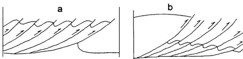
Figura 53 - sistema de leques imbricados. As falhas formam leques que convergem para baixo e se abrem para cima. Na base, juntam-se a uma zona de deslocamento. Em (a) é do tipo imbricado na ponta, em (b), imbricado na cauda (Boyer & Elliot, 1982, apud Hasui & Costa, 1991)
