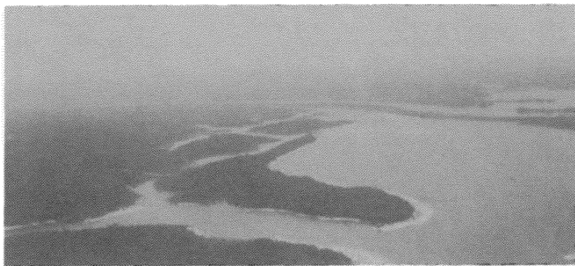
Foto 9 — Lago Batata em processo de assoreamento pela deposição de rejeitos da MRN, em Porto Trombetas. 1987.
