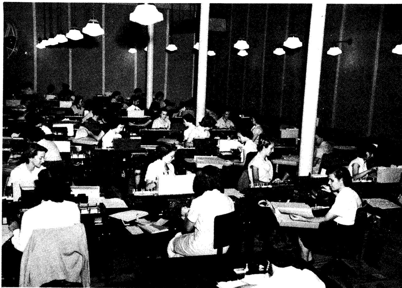
FOTO 5 - Sala de Perfuração. Perfuradoras com teclado fixo e mobiliário constituído de cadeiras com regulagem de altura, permitindo movimento de rotação, com espaldar fixo. Rio de Janeiro, IBGE, Serviço Nacional de Recenseamento, Censo de 1950. (Memória Institucional do IBGE)
