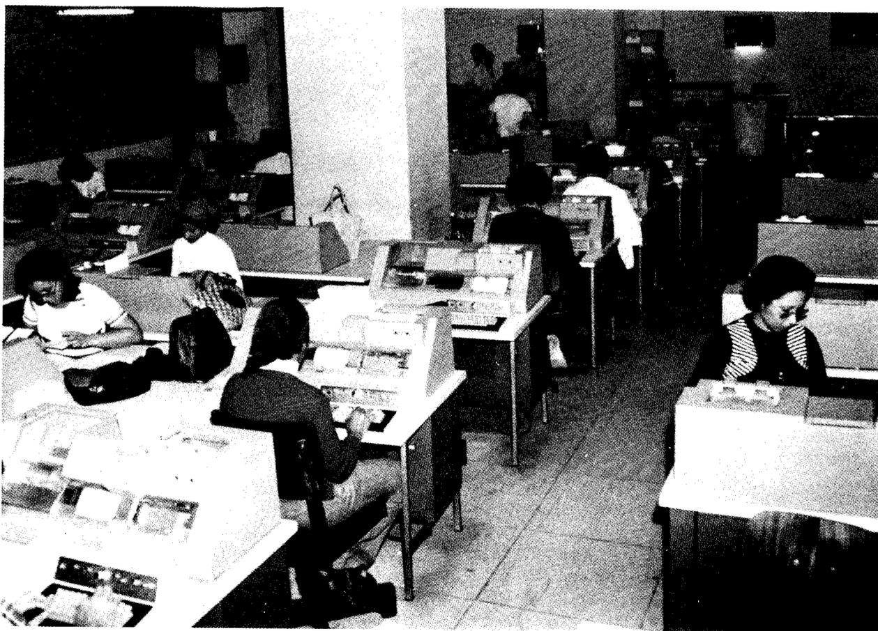
FOTO 14 - Sala de Perfuração. Perfuradora IBM - 029, com teclado removível. Mobiliário constituído de cadeiras, segundo conceitos ergonômicos, condicionamento de ar. Rio de Janeiro, IBGE, Instituto Brasileiro de Informática, Censo de 1970. (Memória Institucional do IBGE)
