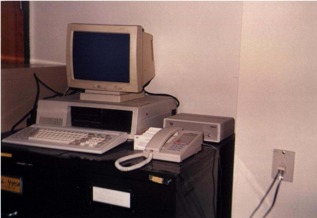
Microcomputador em funcionamento 24 h por dia, transmitindo informações de nível d'água da região de Nova Scotia por linha telefônica (cerca de 30.000 chamadas anuais).
