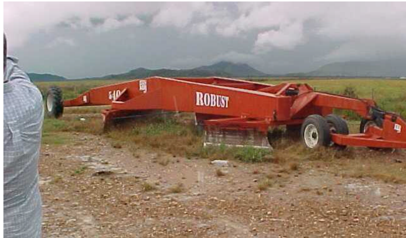
Foto 10– Máquina para preparação de área para plantio de arroz – Faz. Acostumado
