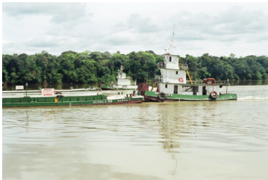
Foto 27 - Barcaças - Rebocadores no rio Branco empurrando barcaças com derivados de petróleo para o terminal da PETROBRAS no porto fluvial de Caracaraí.
