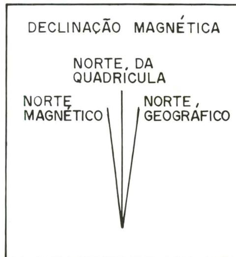
Fig. 18 — Pequena diferença angular existente entre o norte magnético dado pela bússola e o norte geográfico.
