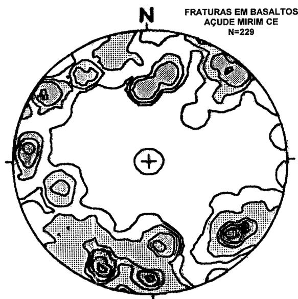
Figura 102 Diagrama de contorno de frequência de juntas
