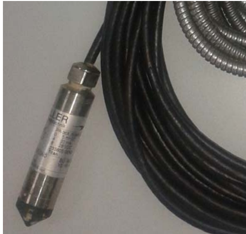
Figura 3 – Exemplo de sensor de pressão, observando-se o cabo preto que conecta o sensor ao dispositivo de desumidificação (não mostrado) e o cabo metálico que conecta este dispositivo ao datalogger.
