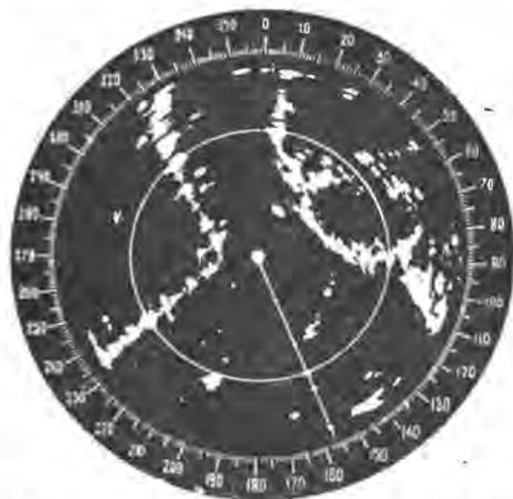
A tela de um radar instalado num navio, registrando a rota de 157° e obstáculos a se desviar.
