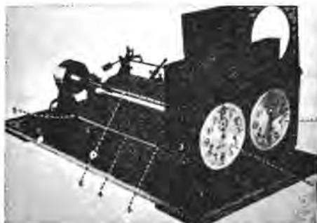
Tipo de marégrafo automático usado na costa brasileira. 1, o relógio; 2, a máquina do relógio; 3, a caixa do relógio; 4, o rolo de abastecimento; 5, as molas reguladoras da tensão; 6, o parafuso do lápis registrador.
