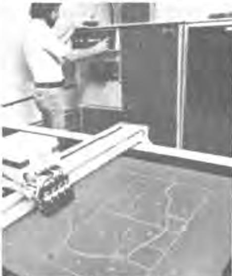
*Dados do processo de aerotriangulação analítica em combinação com outros dados, e alimentados por fitas magnéticas num aparelho traçador automático que grava o mapa diretamente em fotoplástico.*
