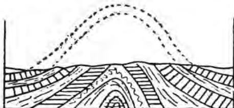
*Corte de um anticlinal, em que a dobra foi destruída pela erosão.*
