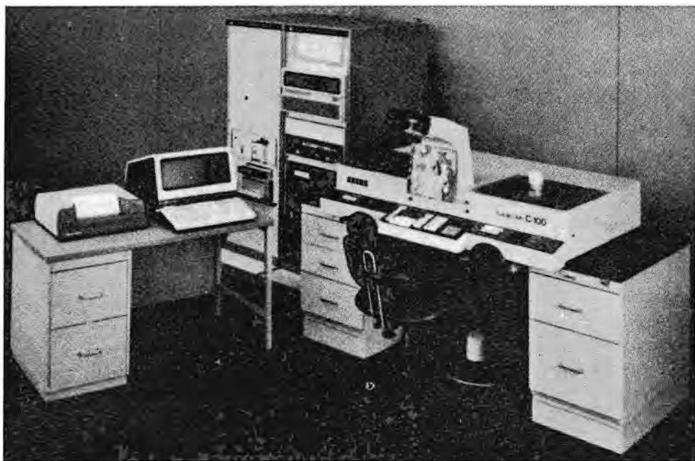
*Sistema estereo-restituídor analítico Planicom C 100, da Zeiss com a mesa de desenho DZ 6. As relações perspectivas fundamentais entre a fotografia aérea e o modelo estereoscópico são estabelecidas sob forma puramente numérica por computação eletrônica.*
