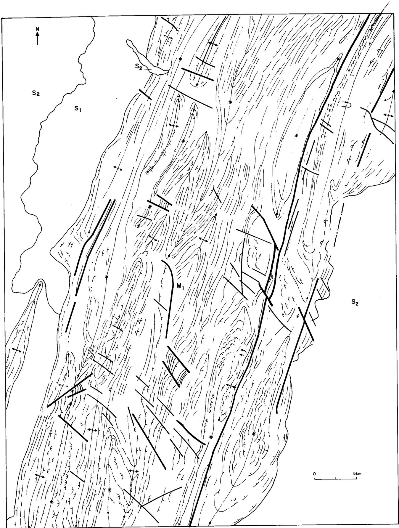
Figura 94 - Estruturas Dobradas em Metassedimentos de Baixo Grau. Folha SE. 21-V-B (Cf. Estampa 55).
