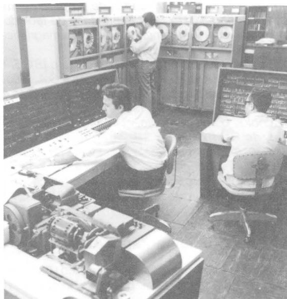
FOTO 7 - Computador UNIVAC 1105. Em primeiro plano, perfuradora de fita de papel, leitora de fita de papel e equipamento Flexo-Writer para mensagens de operação. À direita unidade auxiliar para controle de dois buffers e unidades leitoras de fitas magnéticas. Rio de Janeiro, IBGE, Serviço Nacional de Recenseamento, Censo de 1960. (Manchete Press)
