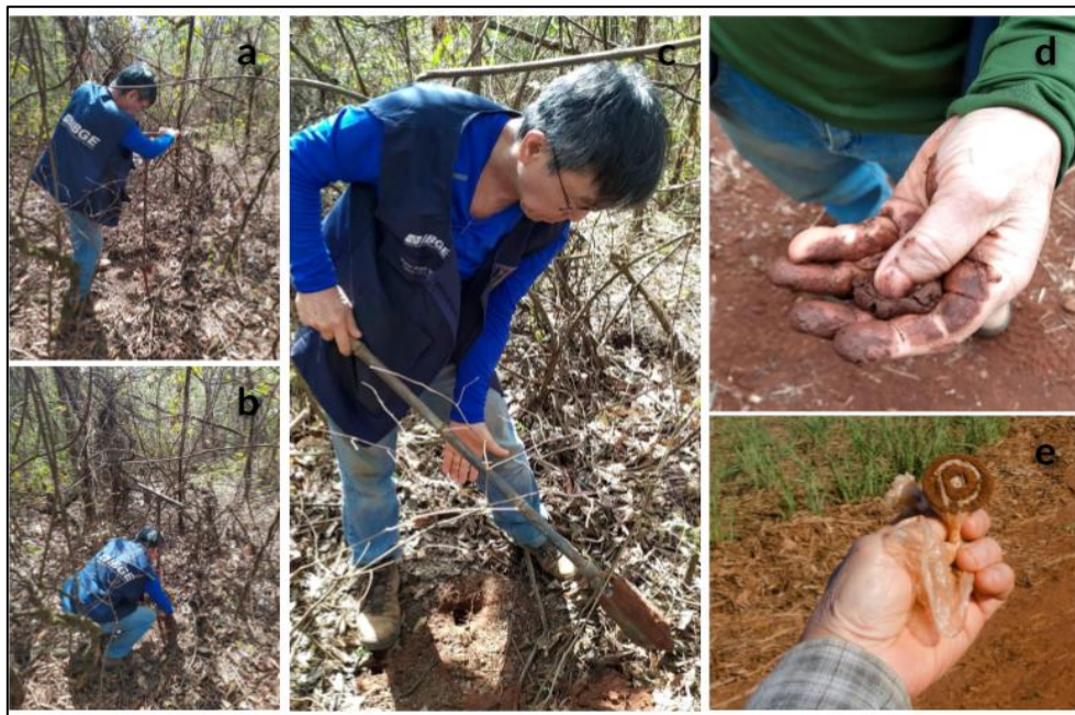
Figura 17: Sequência de tradagem em fragmento florestal próximo a Pedregulho (SP), na unidade de mapeamento SF23-LVdf8* (a, b e c) e determinação de campo do grupamento textural do solo (d). Determinação da suscetibilidade de atração magnética do solo com ímã (e), na unidade de mapeamento SF23-LVwf6 em Ituverava (SP).
