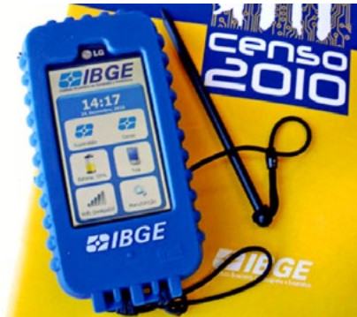
Dispositivo móvel PDA (Personal Digital Assistant) utilizado no Censo Demográfico 2010. O uso do PDA tornou o Censo 2010 o primeiro censo digital do mundo
