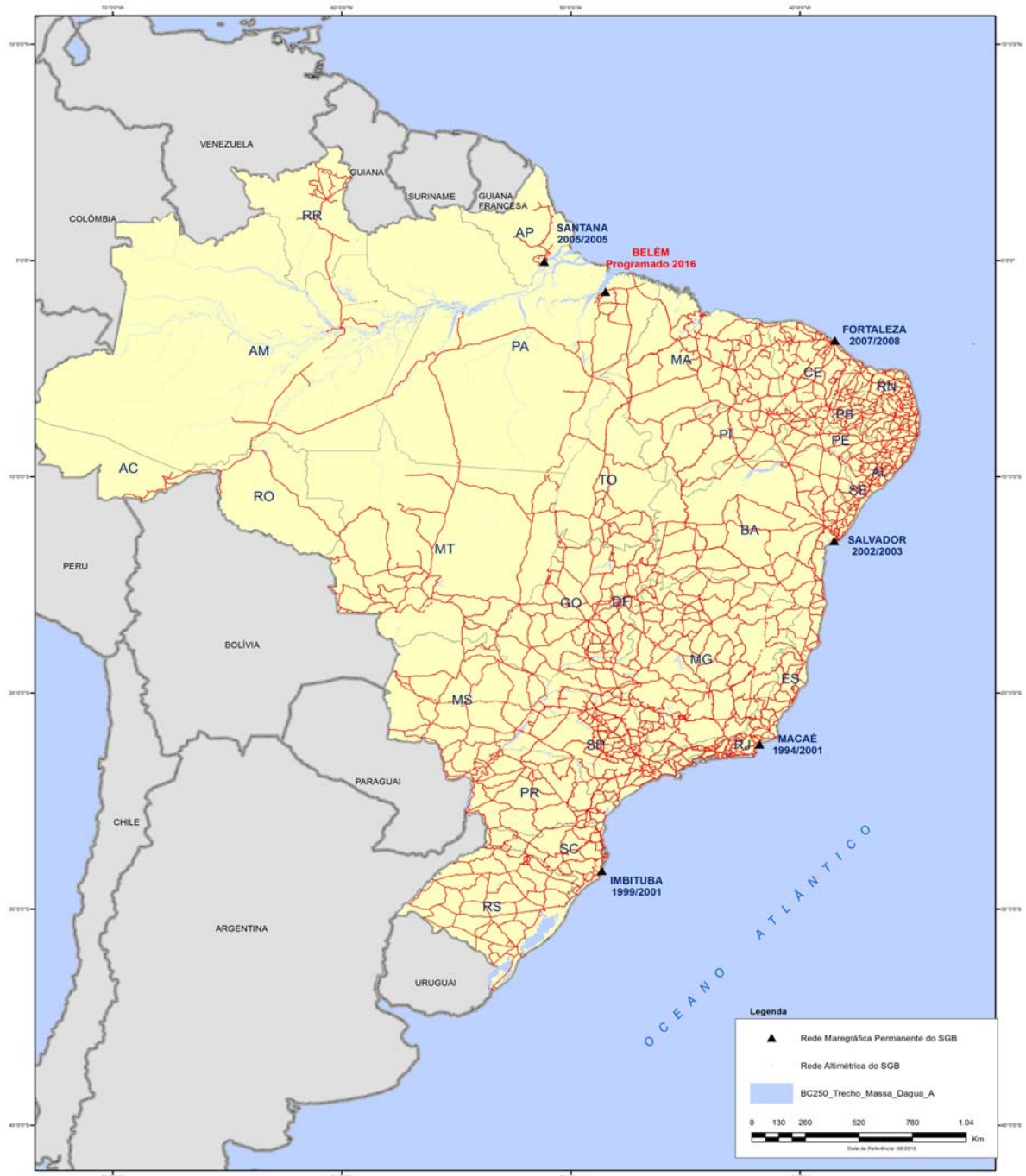
Figura 1 – Cartograma das estações da RMPG com a Rede Altimétrica do SGB; as datas referem-se à instalação dos marégrafos analógicos e eletrônicos.
