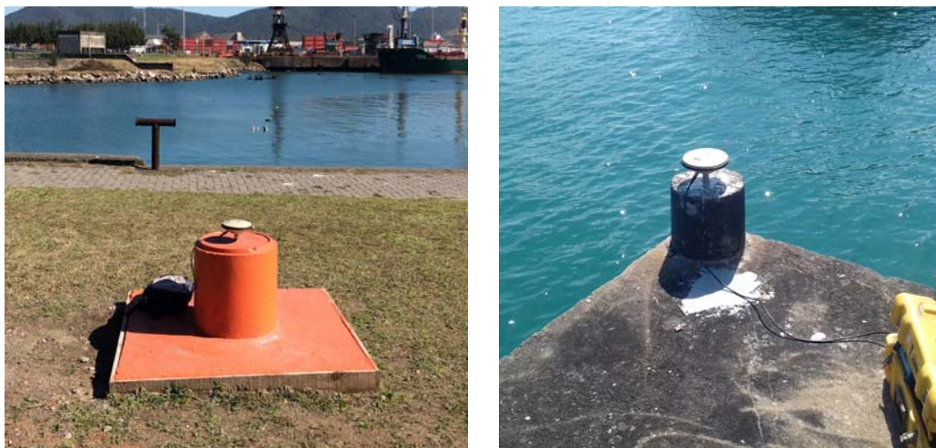
Figura 9 – DCFs implantados no Porto de Imbituba e na Capitania dos Portos da Bahia
