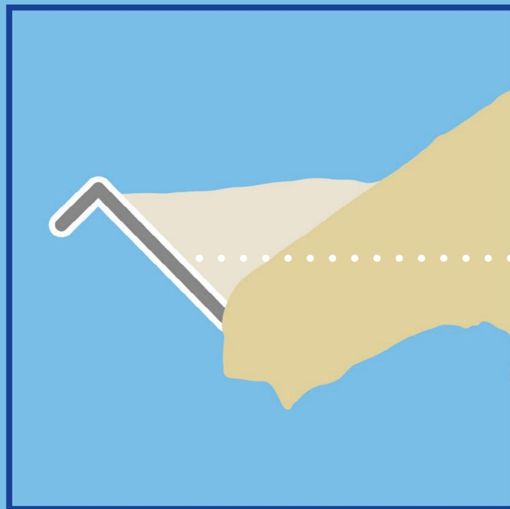
E este é o Espigão Costeiro, construído para evitar a erosão causada pela força da maré na península.
