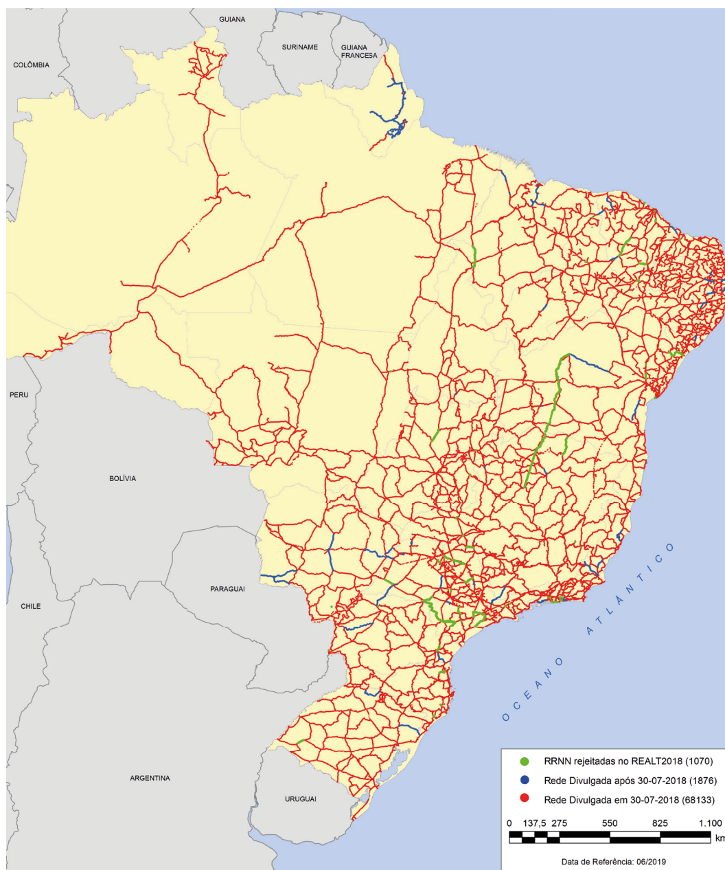
Figura 1 - Rede Altimétrica do SGB após o REALT 2018
