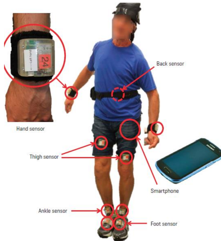
Figura 7 - GaitAssist – assistente de marcha que apoia os exercícios de reabilitação em doença de Parkinson. Fonte: (MANZILU et al. , 2014)
