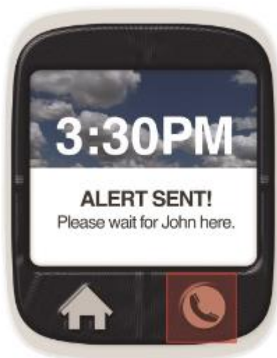
Figura 9 - Rastreador GPS para auxiliar na caminhada de pessoas com demência. Fonte: (NG et al. , 2016)
