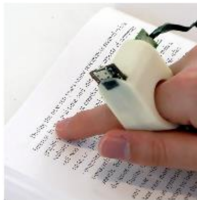
Figura 8 - FingerReader – dispositivo vestível que utiliza os dedos para leitura de textos impressos. Fonte: (SHILKROT et al. , 2015)
