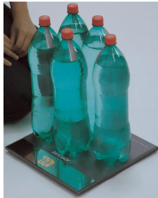
Figura 8: Peso padrão (10kg) utilizado para calibração da balança
